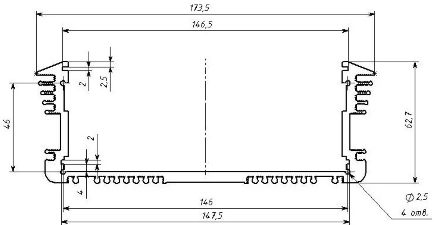
Площадь поперечного сечения -1500 кв.мм
